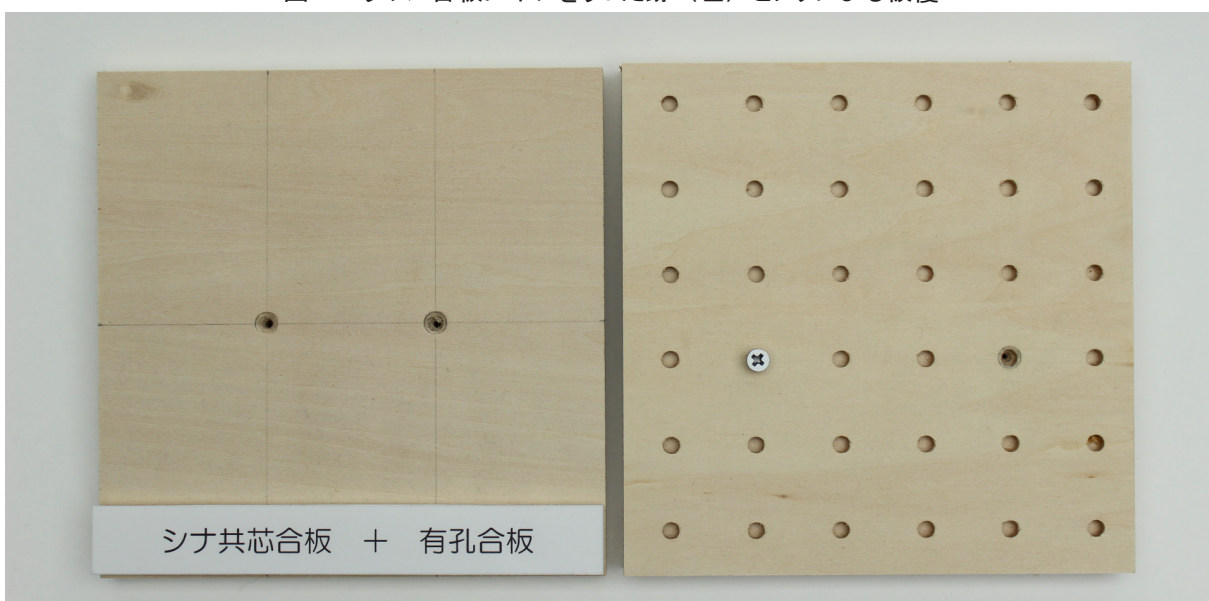
図 13 シナ共芯合板にネジをうった跡（左）と有孔合板による被覆
