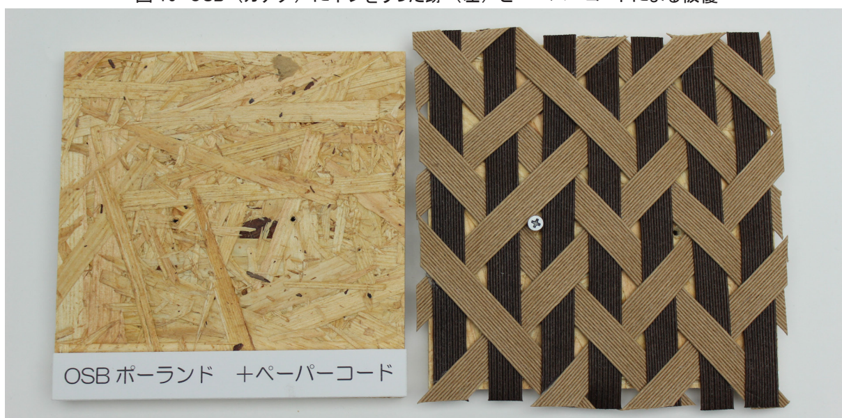
図 16 OSB（ポーランド）にネジをうった跡（左）とペーパーコードによる被覆
