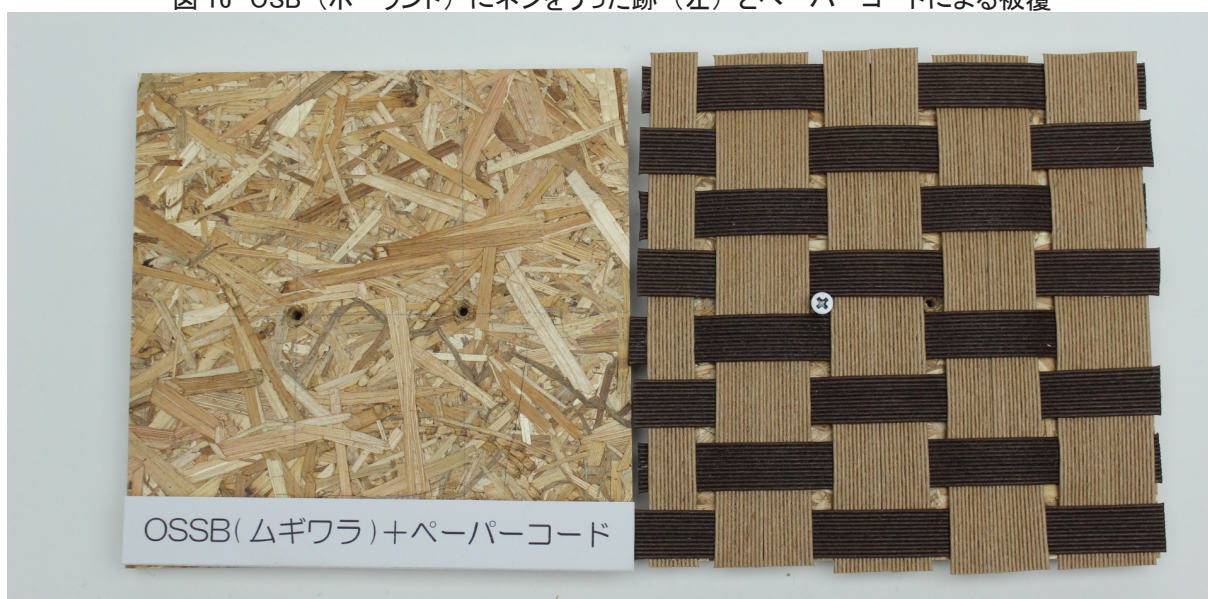
図 16 OSSB（麦ワラ）にネジをうった跡（左）とペーパーコードによる被覆
