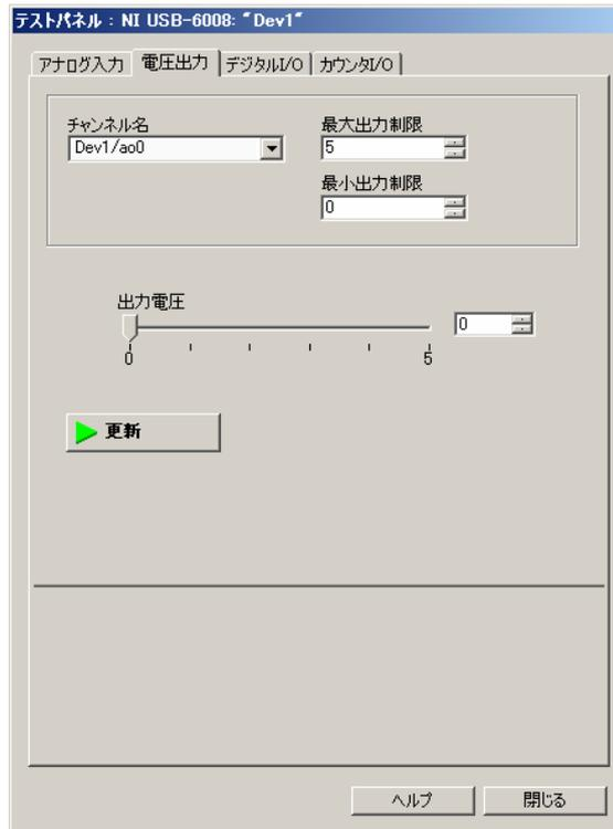
図 58 : MAX プログラムが認識した「NI-DAQmx デバイス」の「USB-6008 ” Dev1”」におけるテストパネル（電圧出力に関するもの）。
