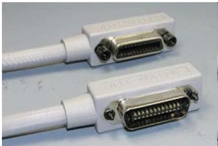
図 50 : GPIB 通信用の専用規格ケーブル
