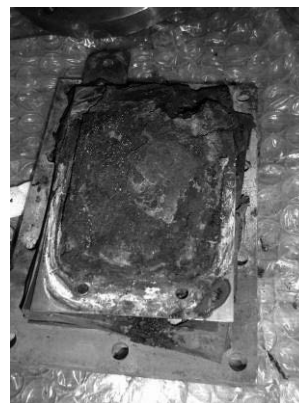
図15. 爆発が起こったPEM水電解試験後のMEAの写真。MEA大型化による不均一性によりナフィオン膜が破れ、水素と酸素の混合により爆発した状態の様子。Reprinted with permission from ref[99]. Copyright 2012, Elsevier.
