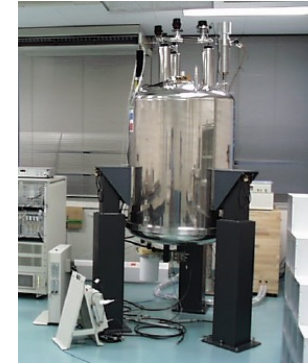
量子計算用の 核磁気共鳴装置(NMR) (大阪大学 北川研究室)
