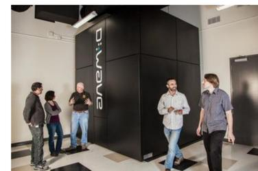
↑D-wave社の量子アニーリングマシン。3m×3mの直方体だが、そのほとんどが冷却器。↓アニーリングマシンの本体。
